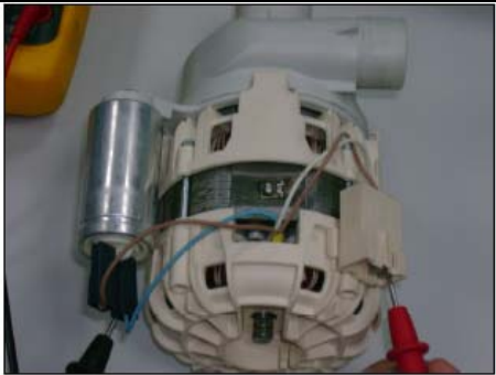
Mesure enroulement secondaire (câble bleu) 125 Ω +/- 7 (NIDEC) 116 Ω +/- 7 (WELLING)
