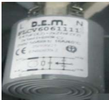
Filtre antiparasite 0,1 \mu F (X1) + 2 \times 0,027 \mu F (Y2) + 1 M \Omega
