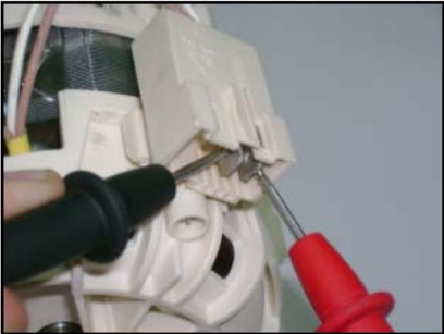
Mesure enroulement primaire 95 Ω +/- 7 (NIDEC) 120 Ω +/- 7 (WELLING)
